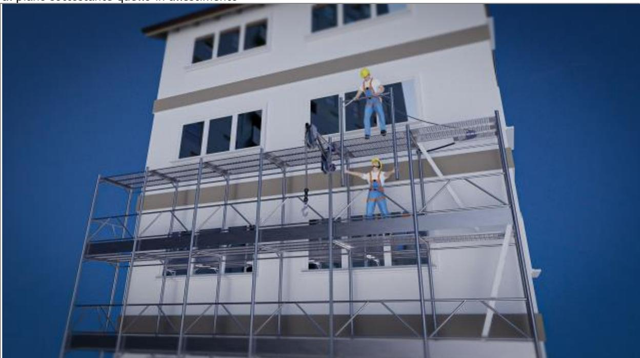
I lavoratori, dopo aver utilizzato l'argano per tirare in quota gli elementi del ponteggio, mediante "passamano", li passeranno al lavoratore in quota.
